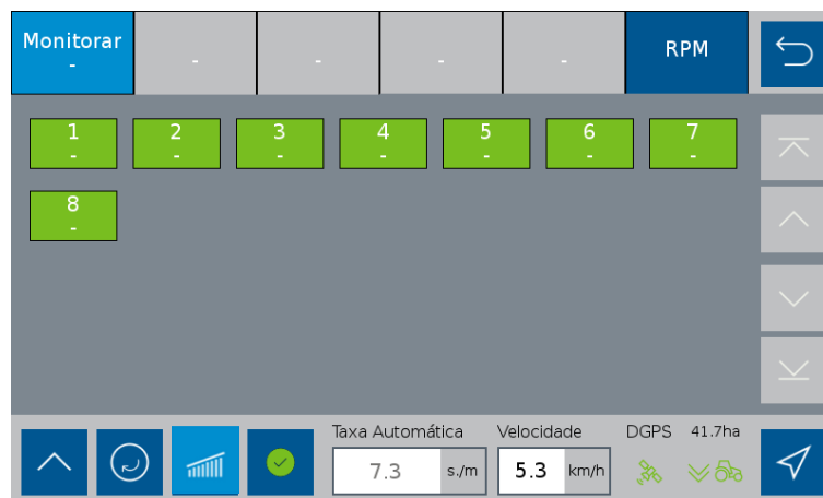
Figura 79 - Tela de monitoramento com controle desabilitado
