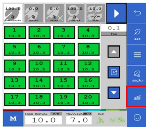
Figura 141 - Botão habilitar/desabilitar corte
