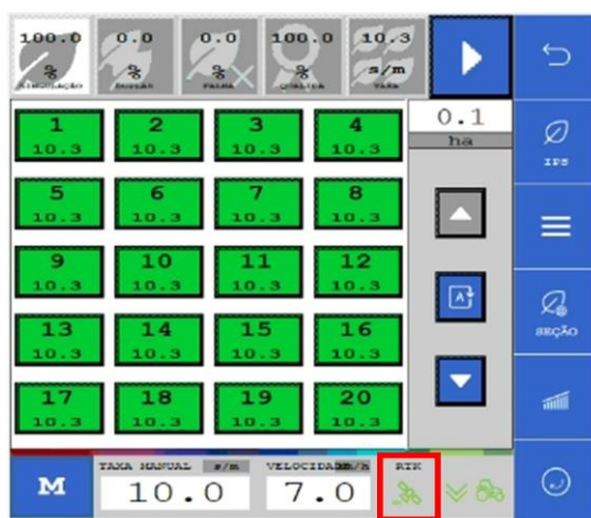
Figura 133 - Indicação do status do GNSS
