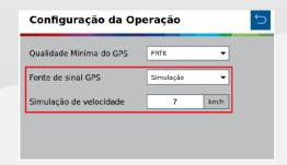
Ao ativar a simulação de velocidade as funções de corte automático, compensação de curva e mapeamento estarão automaticamente desabilitadas
